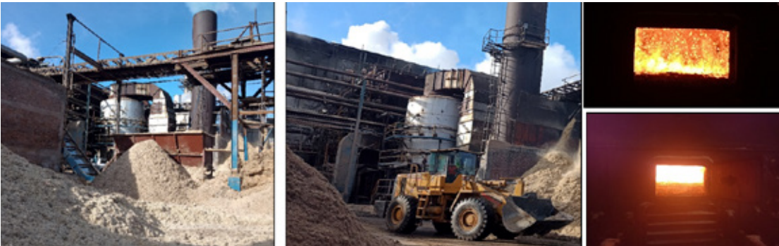
Figura 7. Mezcla bagazo + chips de limoneros alimentada a la caldera. Combustión de la mezcla bagazo + Chips de limoneros.
