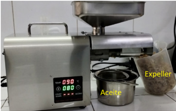
Figura 17. Máquina extrusora para obtención de aceite de semillas de limón y expeller.
