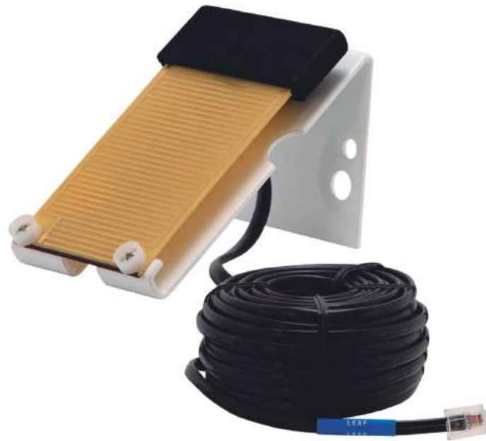
Figura 56. Sensor de humedad de hoja (DAVIS 6420) instalado en algunas estaciones meteorológicas automáticas del área citrícola. Web ( https://davis-wetterstationen.de/6420-davis-blattfeuchte-sensor-leaf-wetness-sensor-p-122.html?sort=6sort_order ).
