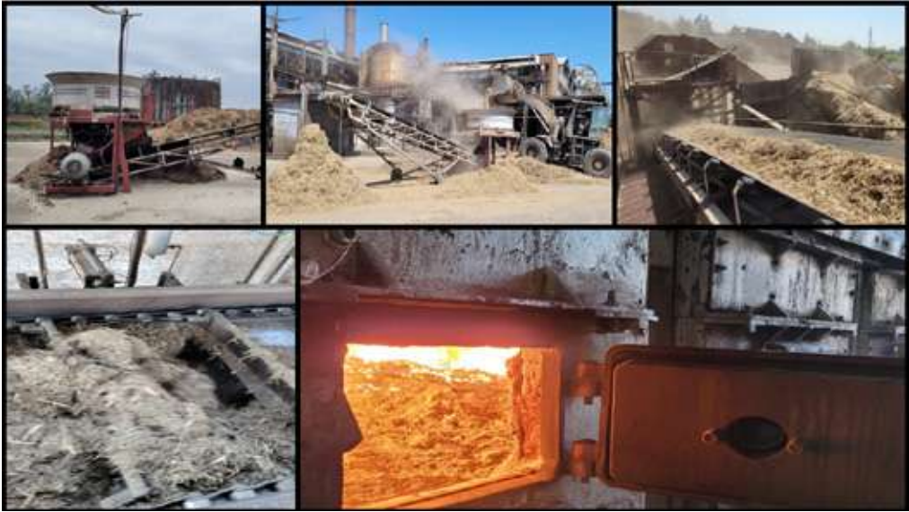
Figura 56. Etapas del procesamiento del RAC para combustión en calderas de biomasa.
